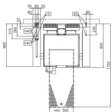
Brasiera a gas basculante, con fondo in compound, 90 lt. (h), carico automatico acqua calda/fredda con rubinetto, doccetta, kit di chiusura posteriore.
